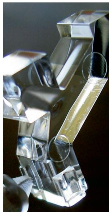
zisionen bezüglich der Oberflächenrauheit im Bereich von zwei bis fünf Nanometern und einer Zentriergenauigkeit der optischen Achsen von +/- 5 µm umgesetzt.
