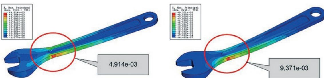
Bild 2: Berechnete Dehnungsverteilung: Anisotrope Eigenschaften (l.), Isotrope Eigenschaften (r.)
